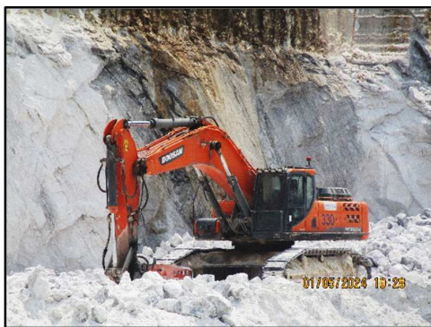
ภาพที่ 2.5 การนำ Hydraulic Breaker ติดหัวกัดมาใช้ในการทำเหมือง
