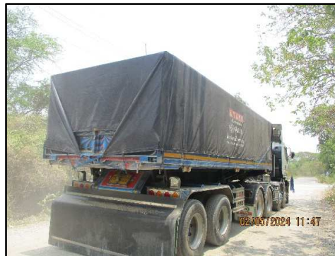
ภาพที่ 2.13 ผ้าใบปิดคลุมกระบะรถบรรทุกที่ขนส่งแร่ออกพื้นที่โครงการ
