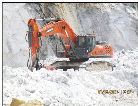
ภาพที่ 2.5 การนำ Hydraulic Breaker ติดหัวกัดมาใช้ในการทำเหมือง
